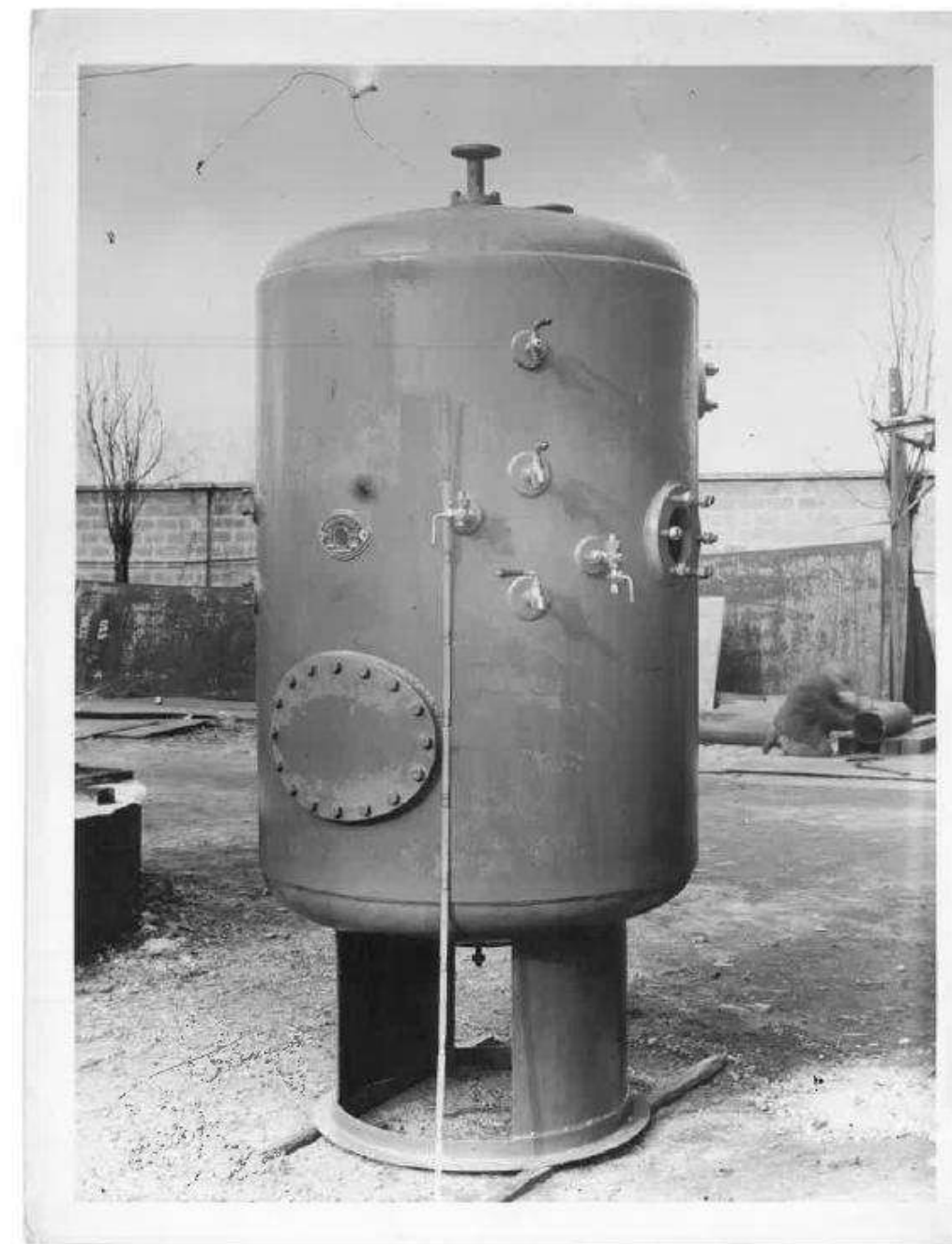
Vaso d'espansione in pressione Materiale Carbon Steel Anni 60
