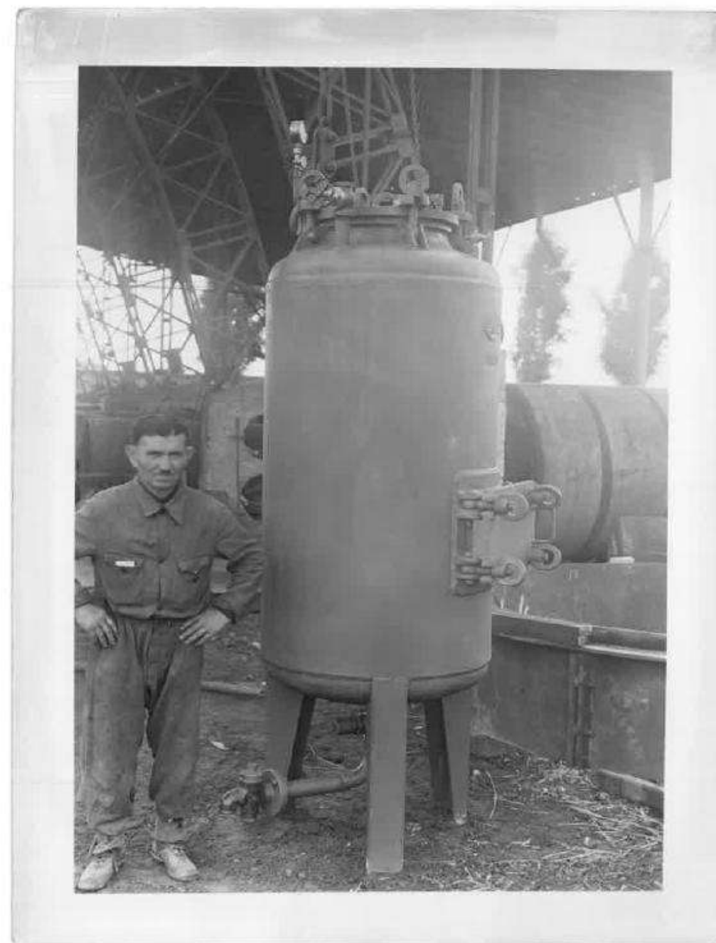
Autoclave per vapore Materiale Carbon Steel Anni 60
