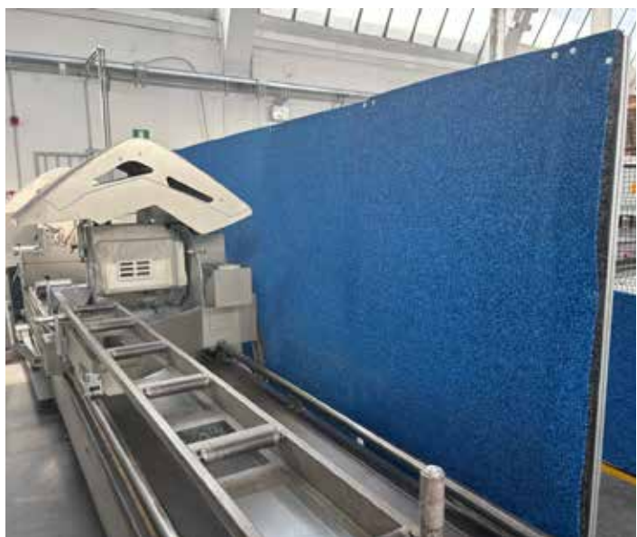
BFLEX ANDY DESIGN applicato su pannello rigido utilizzato come divisorio tra macchinari
