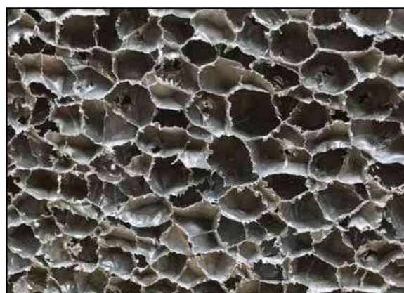
Particolare della struttura cellulare aperte irregolare
