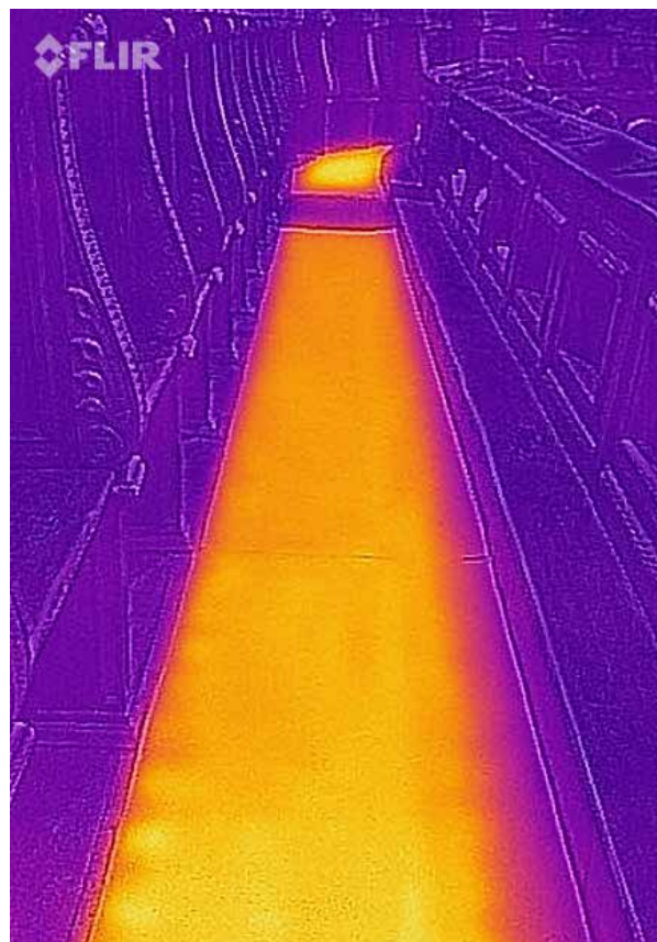
Visione con termo camera del tappeto radiante elettrico acceso con BFLEX BRT/RF applicato ambo i lati
