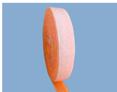
BFLEX FP ULTRA SLIM PLUS LD 30 MY FASCIA ADESIVA TOTALE H 100 mm SP. 5 / 6 / 8 / 10 mm Lunghezza rotolo 25 m
