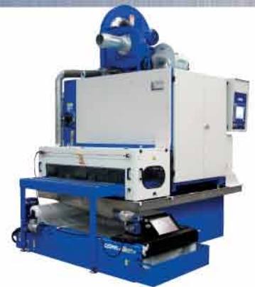
La polvere generata dal processo di lavorazione è portata via da un liquido refrigerante.
